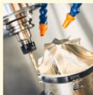
EP AegisOilは石英ガラスやセラミックの加工で発生しがちな微細片の固形化を防ぎ、作業精度を安定的に高めます。また、スクラッチ発生も抑制し美しい仕上がりを実現します。
